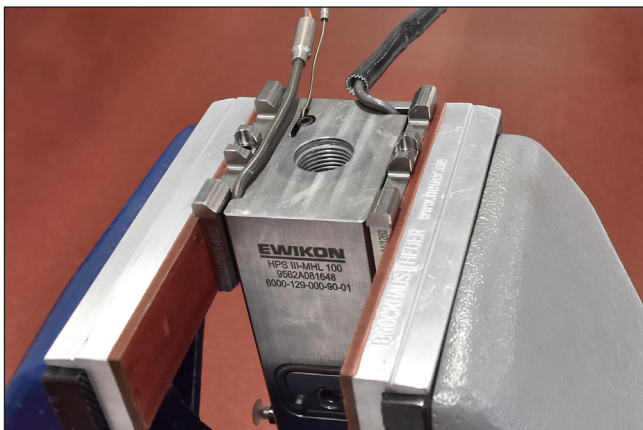
Abbildung 99: Thermofühler in die Bohrung stecken und fixieren
