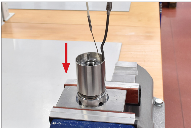
Abbildung 112: Thermofühler verlegen, Schutzrohr nachschieben
