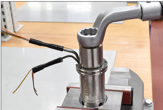
Abbildung 108: Düse einspannen, Adapter demontieren
