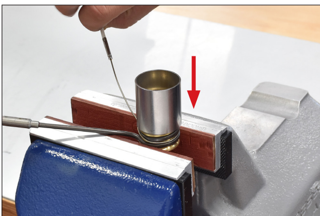
Abbildung 95: Thermofühler aufwickeln, Schutzrohr nachschieben
