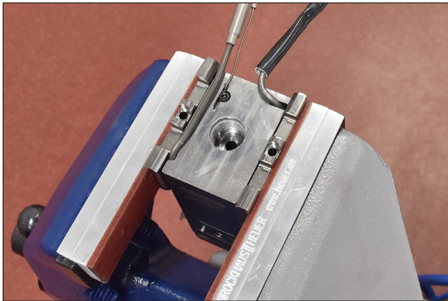
Abbildung 96: Düse einspannen, Schraube lösen
